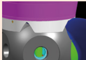
Laufblätter mit reduziertem Spalt
