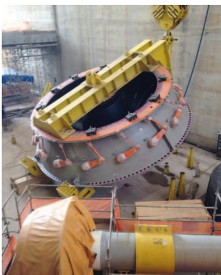
▼ Stator des WKW Belo Monte während der Fertigung
