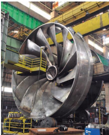
▲ Рабочее колесо радиально-осевой турбины в процессе изготовления
