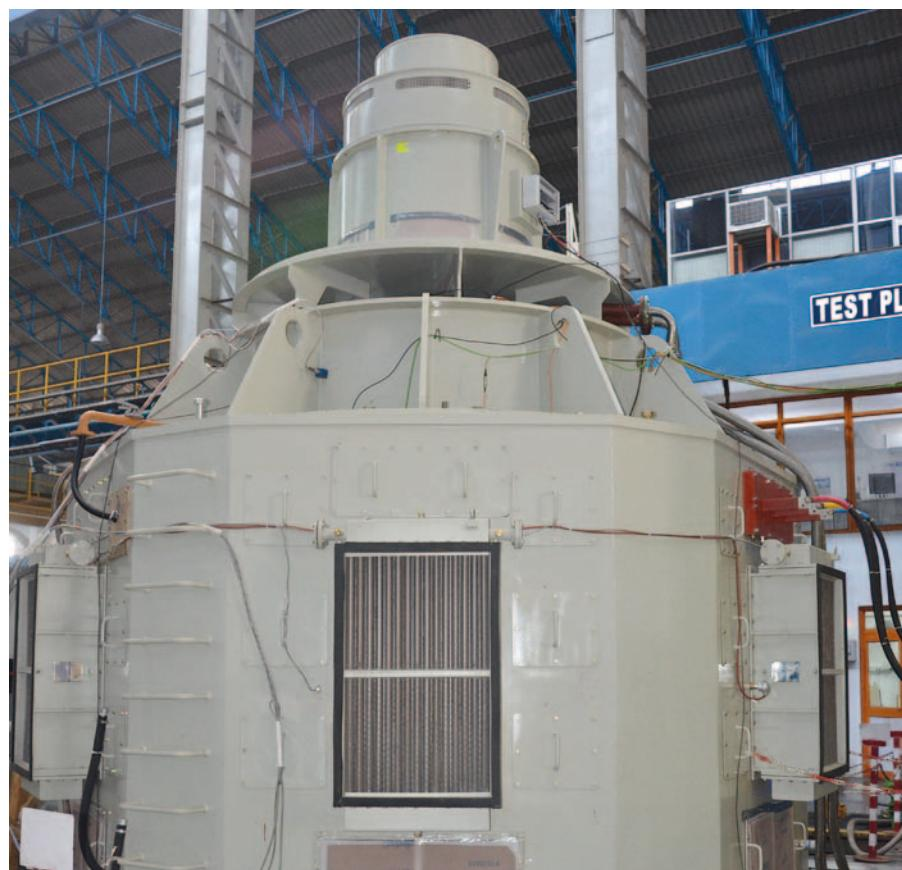
Одна из ключевых характеристик нового испытательного стендла – возможность проведения испытаний при превышении максимальных оборотов до 1 400 об/мин. Подразделение «АНДРИТЦ ГИДРО» в Индии теперь обладает всем необходимым оборудованием для проведения эксплуатационных испытаний генераторов мощностью до 35 МВА как с горизонтальным, так и с вертикальным расположением вала.
