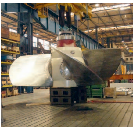
▣ Рабочее колесо поворотно-лопастной турбины в процессе изготовления
