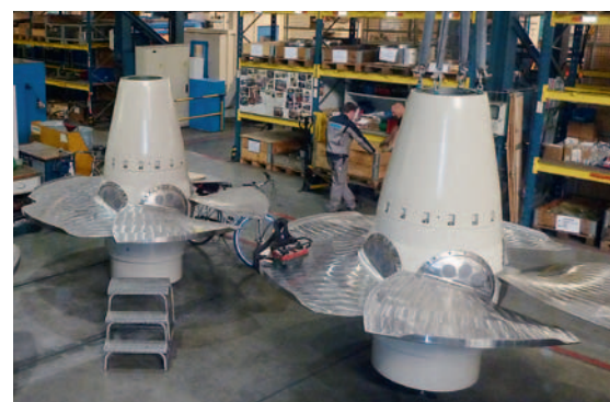
□ Рабочие колеса поворотных турбин для ГЭС «Kashimbila», Нигерия, и «Stortemelk», Южная Африка
